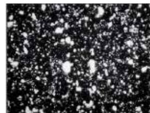
Le punte in polvere di metallo (sinistra) hanno una grana più fine di quelle in acciaio super rapido (destra) e uniforme distribuzione. La durezza 70 HRc garantisce grande resistenza all'usura e al calore.
